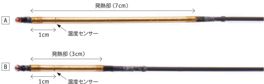
図4 ClosureFAST™ カテーテル A: CF7; 発熱部が7cmで全長が60cmと100cmの2種類 B: CF3; 発熱部が3cmで全長が60cm
